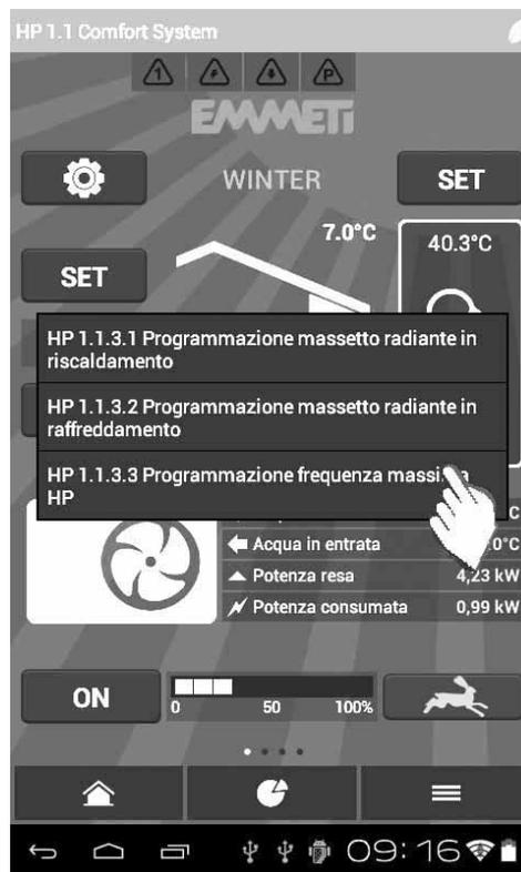
Premere la programmazione massetto radiante che si vuole modificare (3° riscaldamento, 4° raffreddamento).
