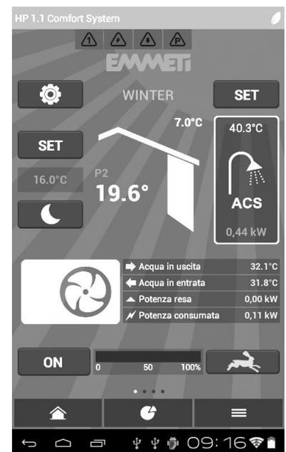
In condizioni di Attenuazione forzata si illumina l'icona della LUNA e viene visualizzata come temperatura di set per l'ambiente interno il set di Comfort comprensivo della variazione in Attenuazione.
