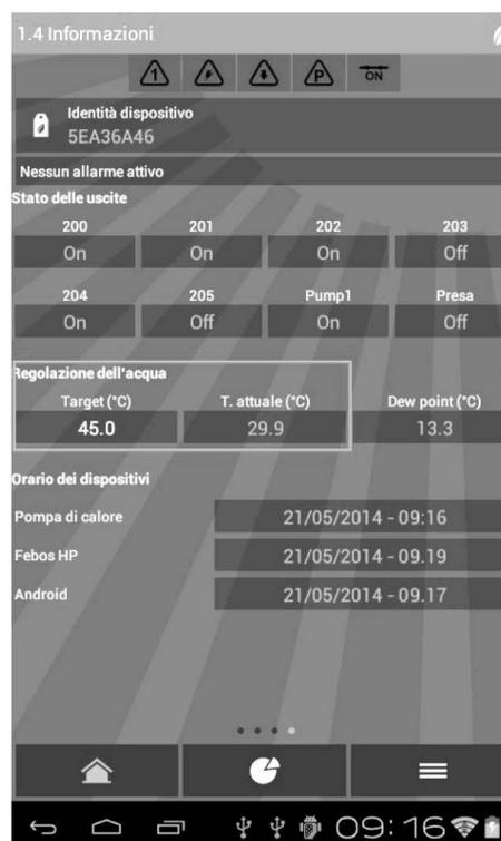
La frequenza del compressore viene regolata in modo che la T. Attuale (L551) raggiunga e mantenga la temperatura di Target (L550). Nel funzionamento al set per il radiante vi sono i seguenti casi:
