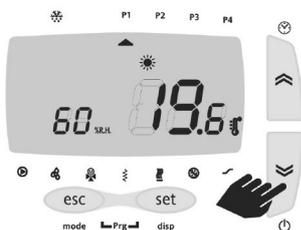
Se la MIRAI-SMI-F è accesa viene visualizzata l'icona del sole o del ghiaccio, a seconda del modo di funzionamento.
